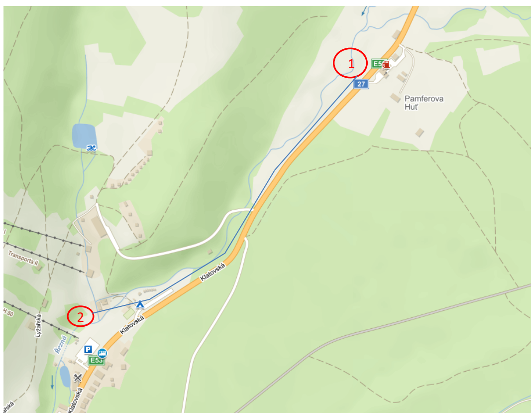
Obr. č. x Vzdouvací objekt (1) bude umístěn v blízkosti silnice I/27 jihozápadně od čerpací stanice F1 Gas. Délka přivaděče od vzdouvacího objektu po strojovnu bude dlouhý cca 950m (tmavě modrá linie). Strojovna (2) bude umístěna na okraji areálu autokempu směrem k Železné Rudě na pozemcích p. č. 386/26, 386/27.
